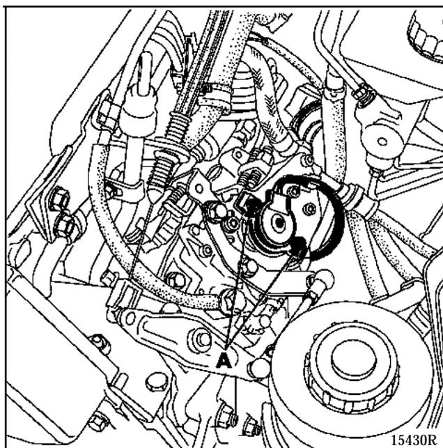
Lire la valeur sur l'outil de diagnostic. Celle-ci doit être de 59 %. Serrer les vis de fixation.
