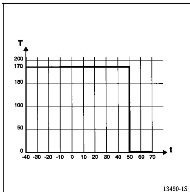
Si le capteur de température d'eau est défectueux, les bougies sont alimentées systématiquement pendant **170 secondes**.
