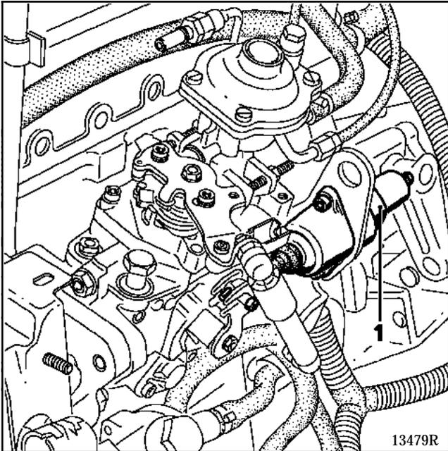
L'alimentation du **KSB** se fait par le boîtier électronique.
