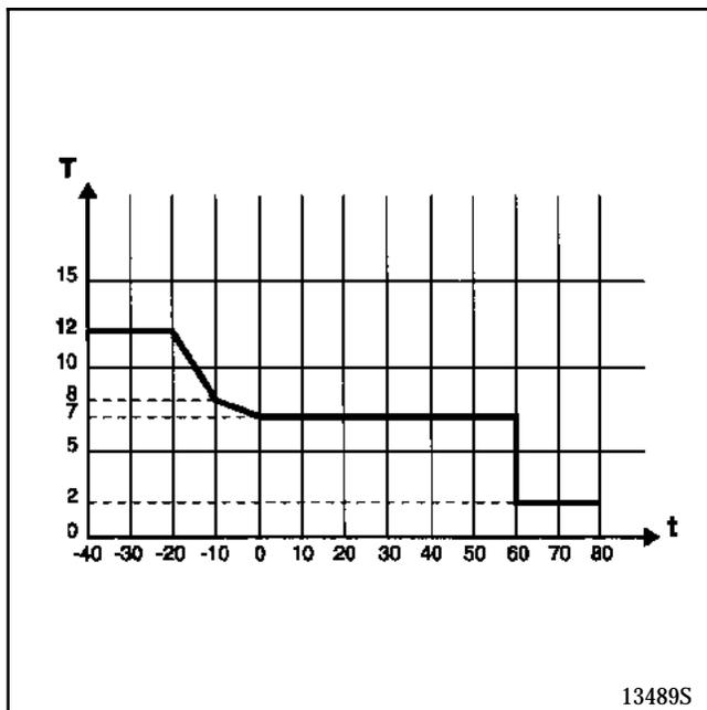
Si le capteur de température d'eau est défectueux, les bougies sont alimentées systématiquement pendant **12 secondes**.
