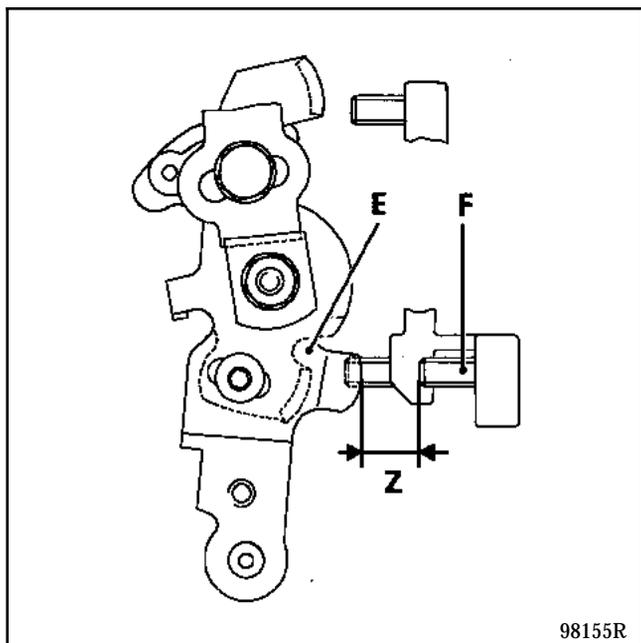
**NOTA :** le réglage de la butée (F) est effectué au banc d'injection. Ne jamais modifier ce réglage.
